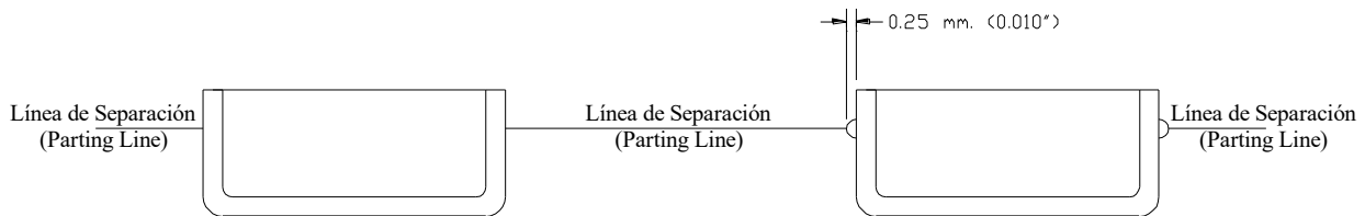
Punto Medio de la Línea de Separación (Midpoint Parting Line)
